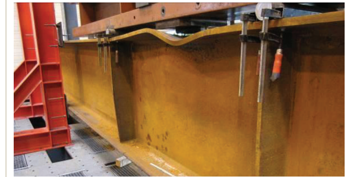
Fig. 23. Comparación entre la prueba de flexión de 4 puntos y la simulación de EF.
