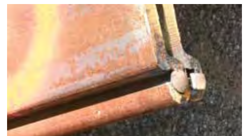
Boulon inséré dans la serrure à l'avancement
