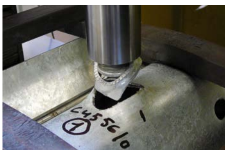
Испытания болтовых соединений
