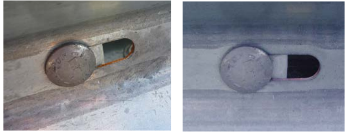
Защитные ограждения производства Mieres Tubos/Grupo Condesa, покрытые Magnelis® ZM310 (толщина стали 3 мм). Испытания начались на открытом воздухе в сентябре 2011 (слева). Обратите внимание на эффект самовосстановления в зоне перфорированных отверстий в октябре 2013 г. (справа).
