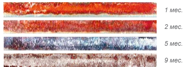
Самовосстанавливающаяся защита Magnelis® ZM310 после атмосферного воздействия (толщина стали 5,5 мм)
